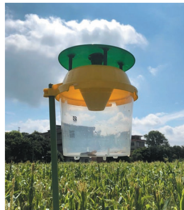
Рис. 5. Пластиковая накопительная ловушка в рабочем состоянии (фото компании ООО «Пекинская компания биотехнологий «Феробио»)
