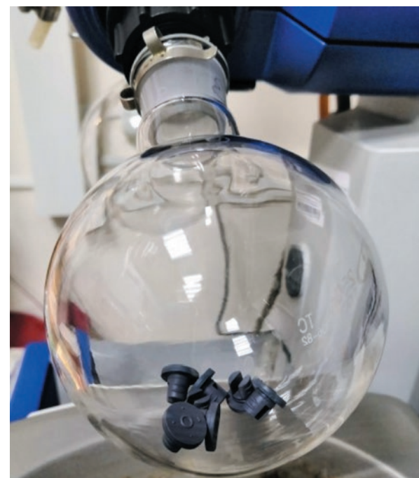
Рис. 4. Диспенсеры из бромбутильного каучука в процессе импрегнации (фото Н.И. Кулаковой)
