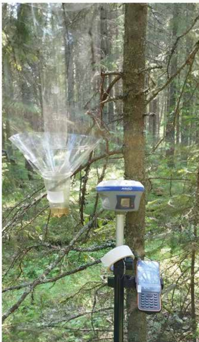
Рис. 2. Барьерно-вороночные ловушки прозрачной (слева) и черной (справа) конструкции, GNSS-приемник PrinCe i90 для фиксации координат (слева)
