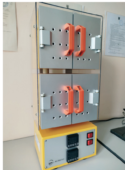
Рис. 5. Установка АСЭШ-8-2 используется для определения влажности зерна (фото: А. О. Плиско)
