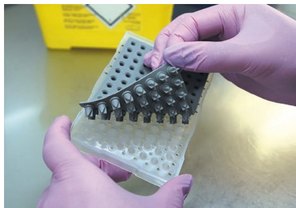
Рис. 3. Закрывание плашки для секвенирования резиновой септой Fig. 3. Closing the sequencing plate with a rubber septum
