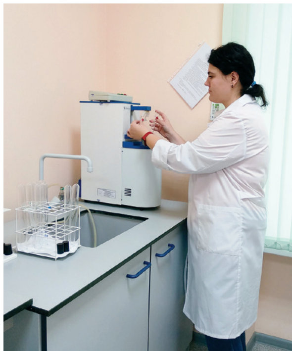
Рис. 3. Определение числа падения с помощью прибора ПЧП-3 (фото: А. О. Плиско)
